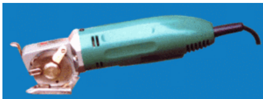
Рис. 15. Электрические раскройные ножницы марки WD-1 (Япония)
