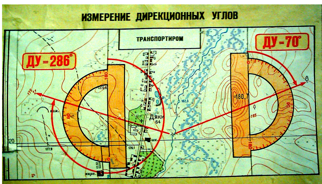
Рис.1 Измерение дирекционных углов транспортиром по карте
