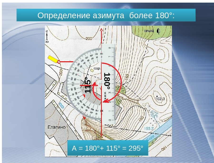
Рис. 3 Определение азимута географического по карте (азимут обратный)
