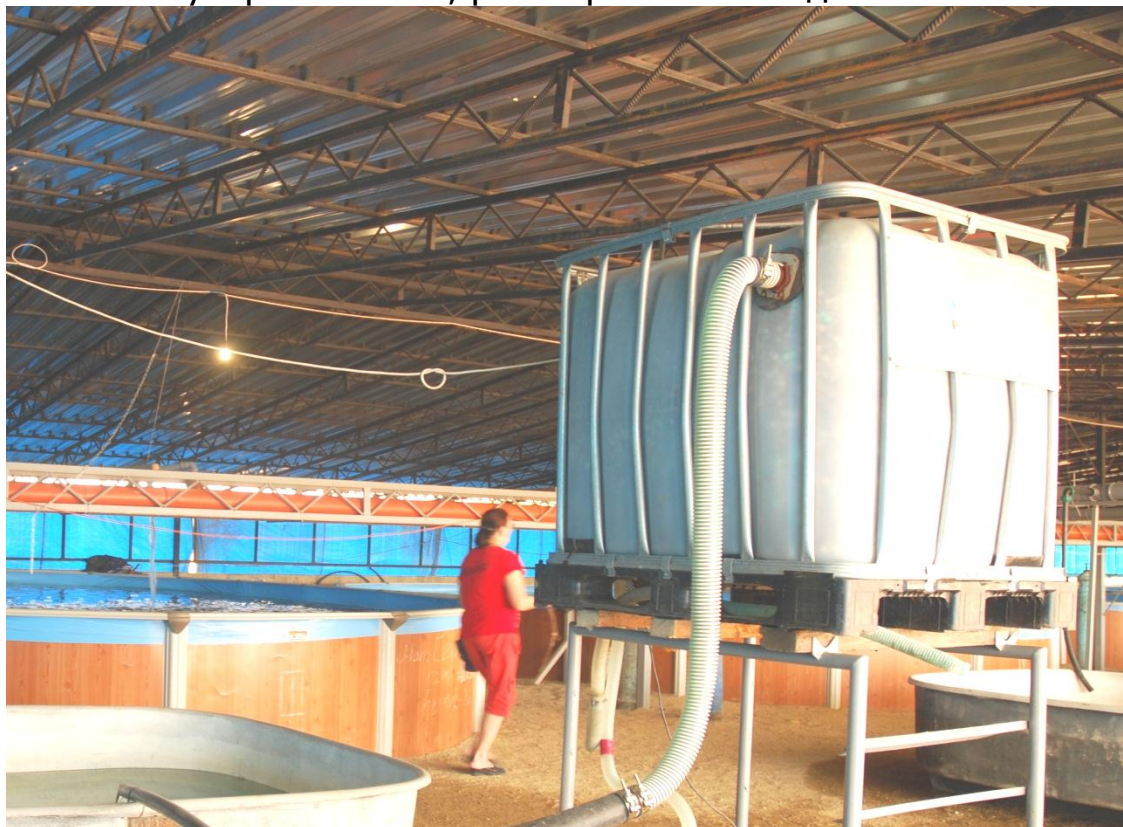
Рисунок 9. Бак – дегазатор, наполненный специальной загрузкой. Затем вода подается в бассейны через аэратор, где насыщается кислородом.
