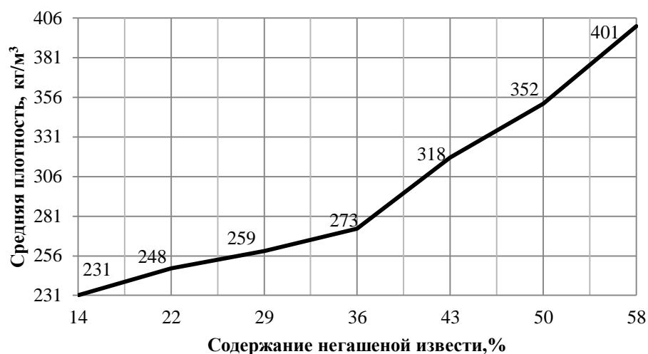
Рис. 4. Зависимость средней плотности от химического состава образцов
