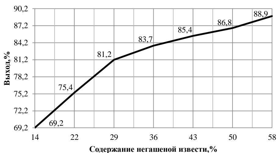
Рис. 2. Зависимость выхода теплоизоляционных материалов от содержания негашеной извести
