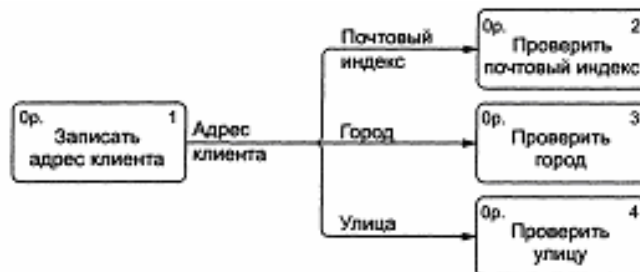
Рис. 5. Разветвление стрелки, иллюстрирующее декомпозицию данных
