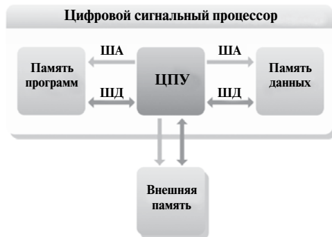
Рис. 3.6. Гарвардская архитектура DSP
