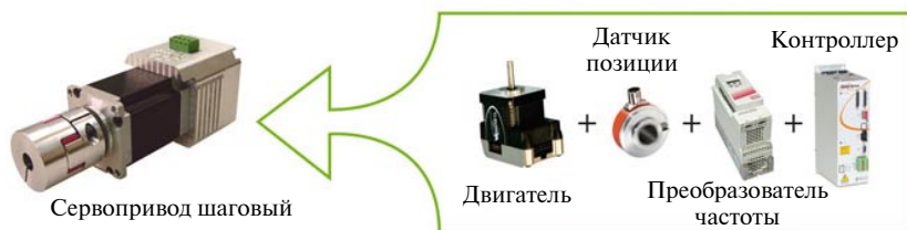
Рис. 3.4. Схема гибридизации привода СПШ 10
