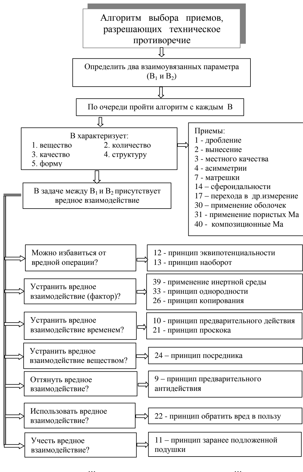
Рис. 7. Алгоритм выбора приемов, разрешающих техническое противоречие
