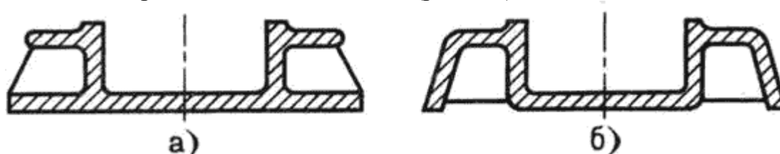
Рис.8.9. Устранение пазов в конструкции литой детали
