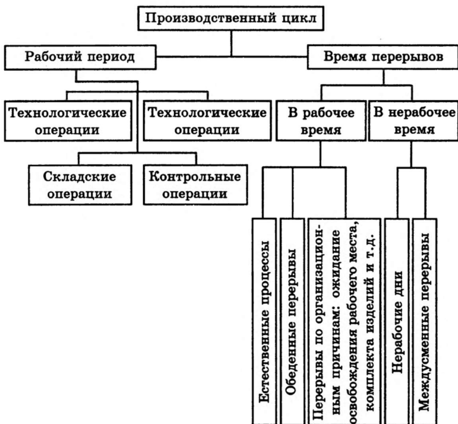
Рис. 2.1. Структура производственного цикла
